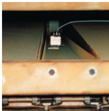
Montagebeispiel: Einbau einer HP-250A Sonde zwischen 2 Düsenkästen
